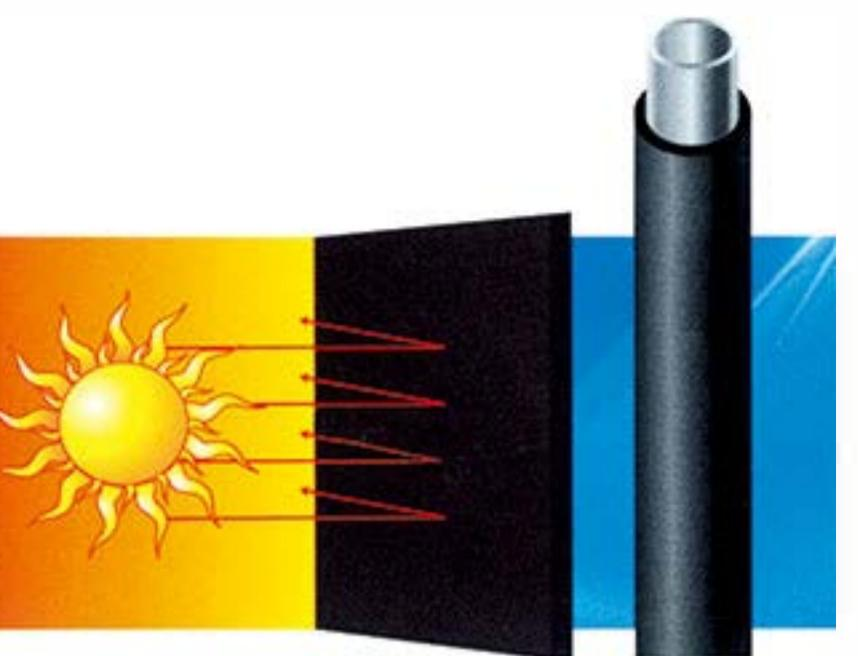
本品导热系数低，平均温度为0°C时为0.034w/m·k，表面放热系数高，达到9.5w/m·k，因此在相同的环境条件下，它的使用厚度比其它的温湿度材料薄一半以上，节省了楼层吊顶上的空间，从而增加了楼层的可利用空间。
