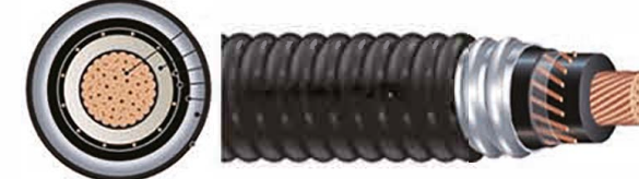
Teck 90 1/C Cu 1KV XLPE/PVC AIA PVC-NS
