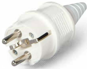
GPS-579 / GPS-580 插头 Plug 电流 Current(A):16A 电压 Voltage(V):220-250V~ 防护等级 Protection degree:IP44
