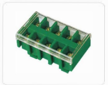
GPS-348 导线截面 wire section: 2.5-4mm 2 额定电流/电压 rated current/voltage: 32A/660V 位数 Pole: 1P、2P、3P、5P 型号 item: 4/1、4/2、4/3、4/5
