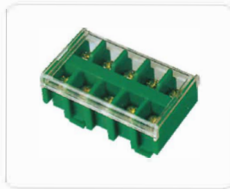
GPS-347 导线截面 wire section: 0.5-2.5mm 2 额定电流/电压 rated current/voltage: 24A/660V 位数 Pole: 1P、2P、3P、5P 型号 item: 2.5/1、2.5/2、2.5/3、2.5/5
