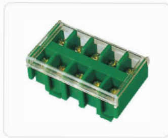
GPS-349 导线截面 wire section: 2.5-6mm 2 额定电流/电压 rated current/voltage: 41A/660V 位数 Pole: 1P、2P、3P、5P 型号 item: 6/1、6/2、6/3、6/5
